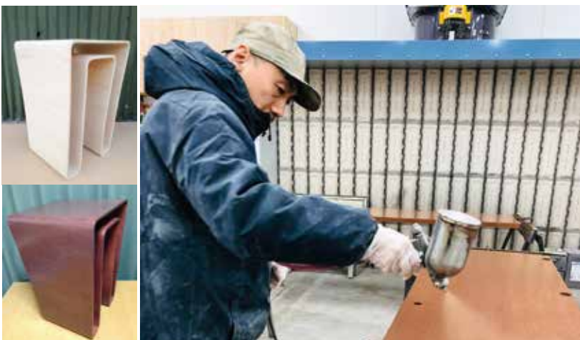
実際の吹付塗装の様子と施工品
