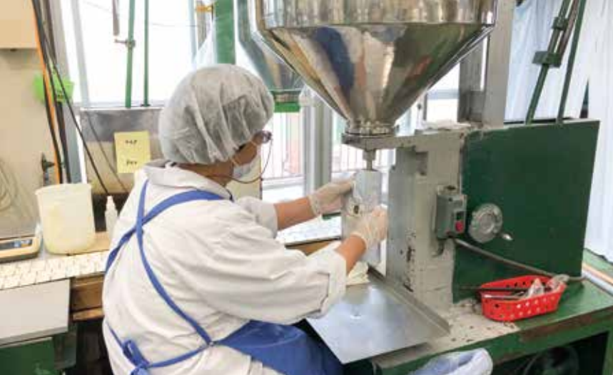
工場での製造風景 1つ1つ丁寧にパッキングしています
